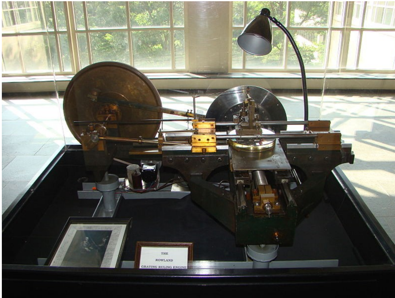
„Ruling engine” Rowlanda (Chhe, 2009) Umożliwiał nacinanie nawet 800 linii na milimetr.
