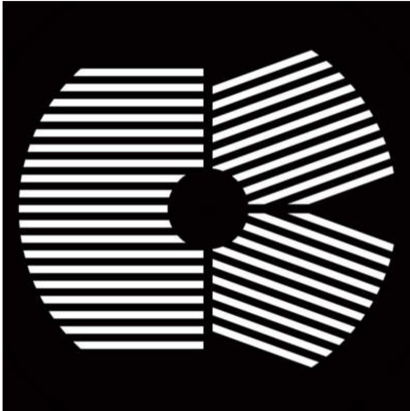
Maska Bahtinova – jej założenie ułatwia zogniskowanie teleskopu ( en.wikipedia.org )
