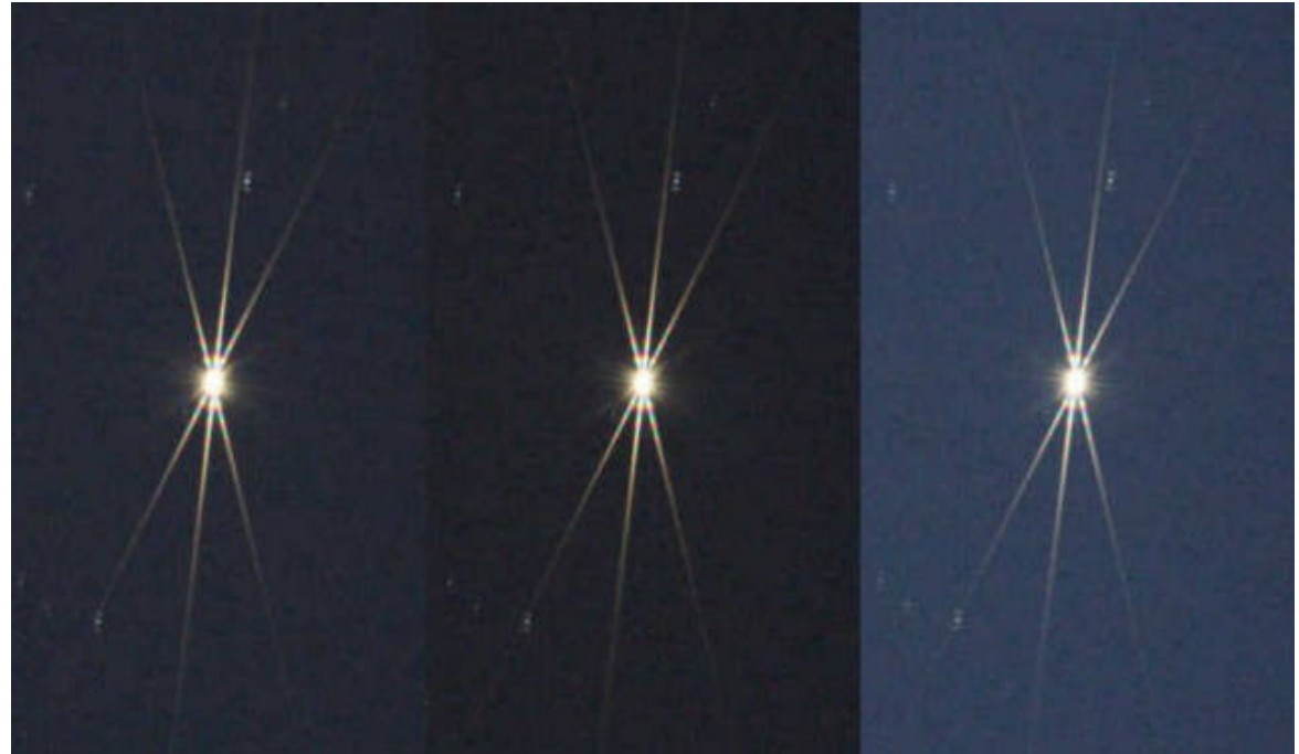
Obrazy gwiazdy w teleskopie z maską Bahtinova założoną na obiektyw ( en.wikipedia.org ).
