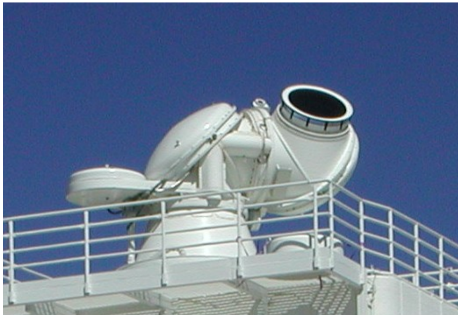
110cm refraktor – Szwedzki Teleskop Słoneczny pojedyncza soczewka nie-achromatyczna (La Palma 2002r)
