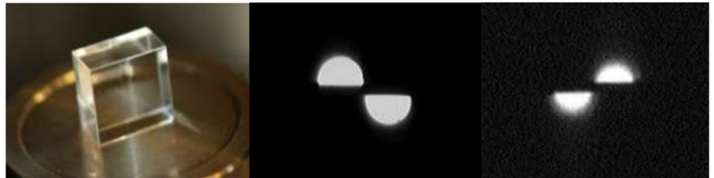
Image slicer zbudowany z dwóch kostek szklanych, prototyp i przykłady działania dla obrazów o rozmiarach 100\mu\text{m} i 50\mu\text{m} (Avila i in., 2012).
