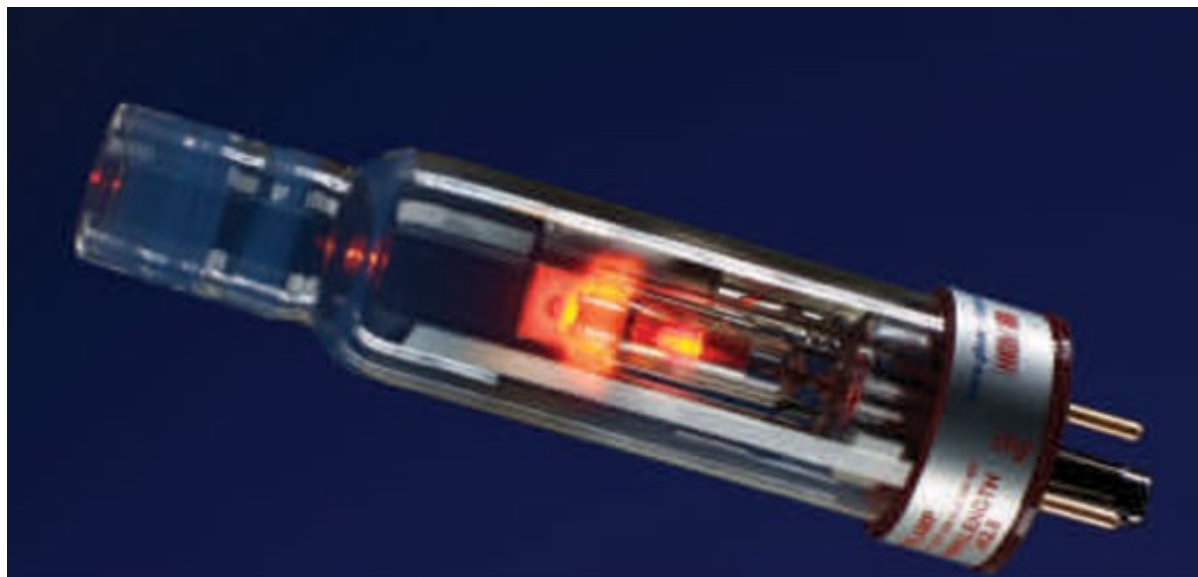
Lampa gazowa typu HCL (lab-training.com)
