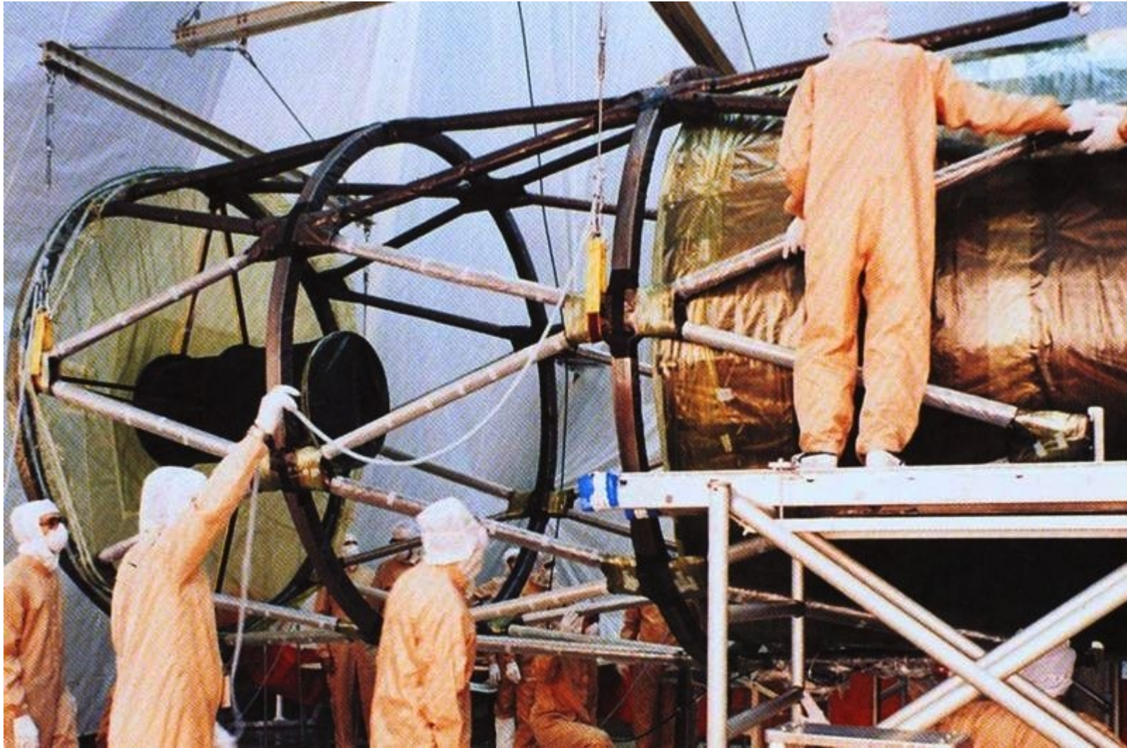
Kratownica z włókna węglowego wewnątrz tubusu teleskopu.
