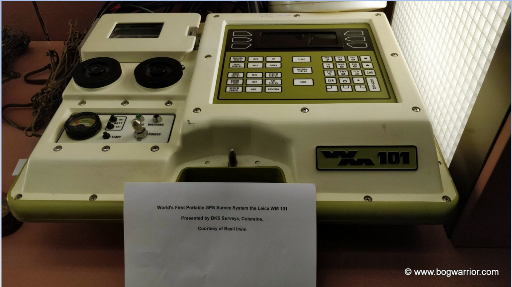
Pierwszy mobilny geodezyjny odbiornik systemu GPS: Leica WM-101 (1985)
